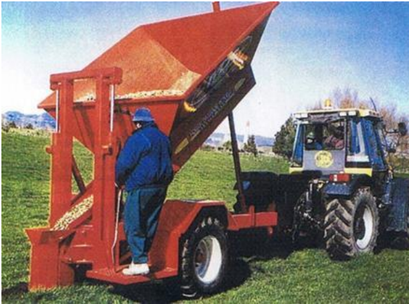
Şekil 13.6 Arazide mol drenaj döşenmesi ve kumçakıl materyalle doldurulması
