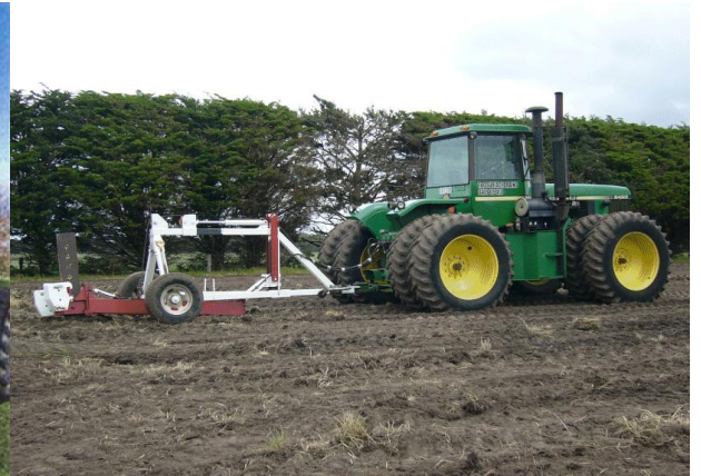
Şekil 13.6 Arazide mol drenaj döşenmesi ve kumçakıl materyalle doldurulması
