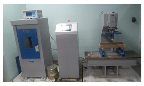
Şekil 1. Beton basınç ve eğilme deneyi
