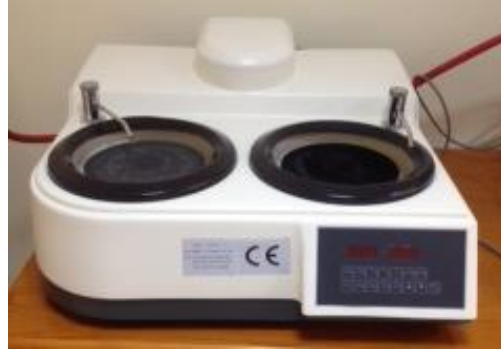
Şekil 7. Numune zımparalama ve parlatma tezgâhı.
