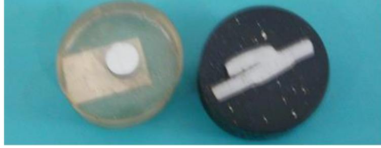
Şekil 5. Polyestere alınmış numune Bakalite alınmış numune
