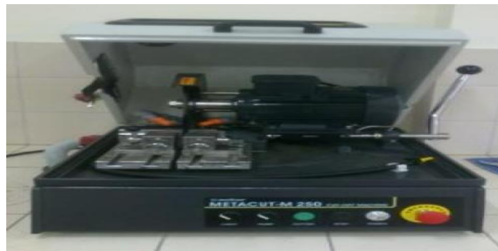
Şekil 2. Hassas numune kesme (Sulu kesme) cihazı
