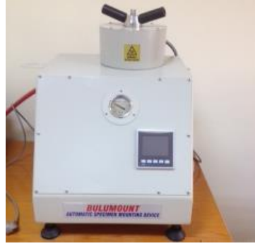
Şekil 3. Bakalite alma cihazı (sıcak kalıplama)
