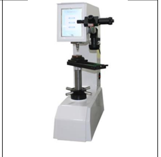
Şekil 3. Rockwell, Brinell, Vickers Sertlik Ölçüm Cihazı
