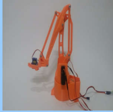
Şekil 1. 3D printer ile basılmış robotkol ve servo motorlar (demonte)
