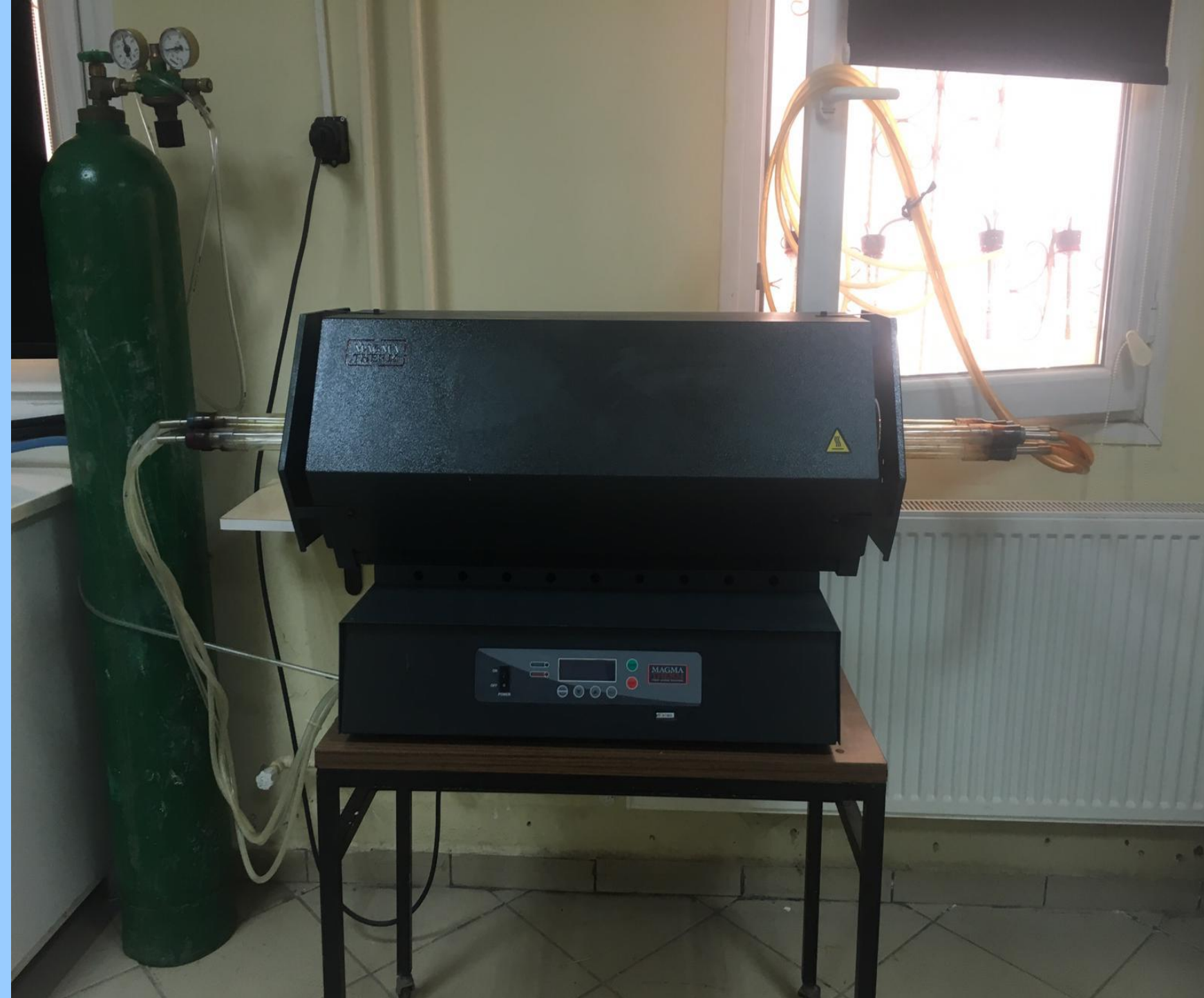
Şekil 3.Akışkan Yataklı Termoreaktör
