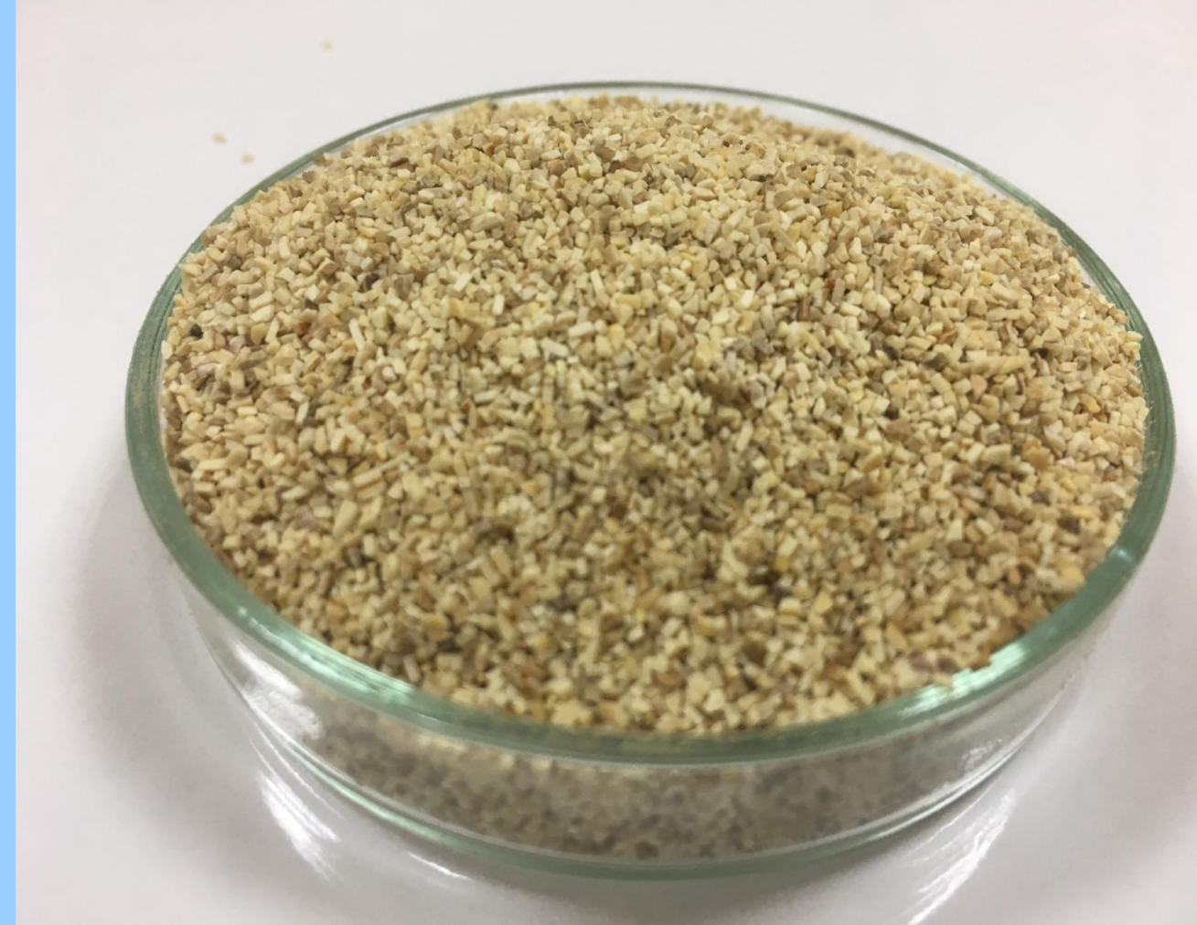
Şekil 2. Elekten Geçirilmiş Fıstık Kabuğu
