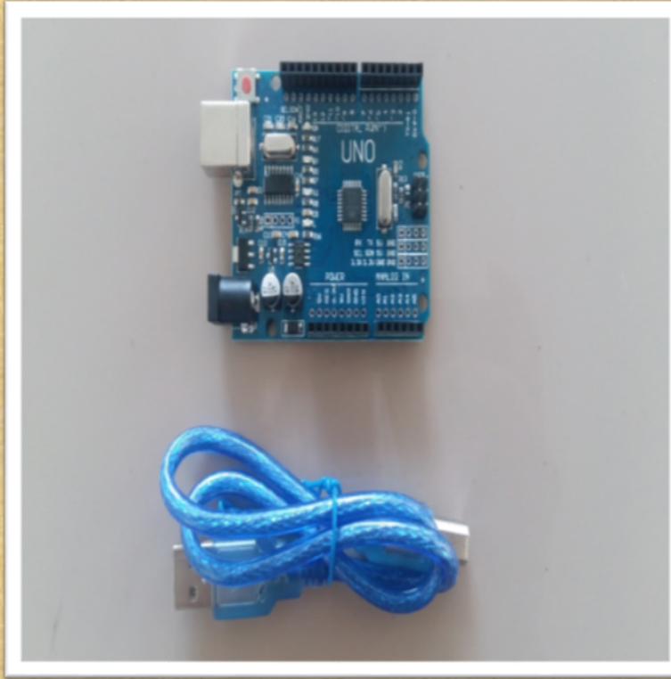
Şekil 2. Arduino uno (temel kod ve kontrol birimi)
