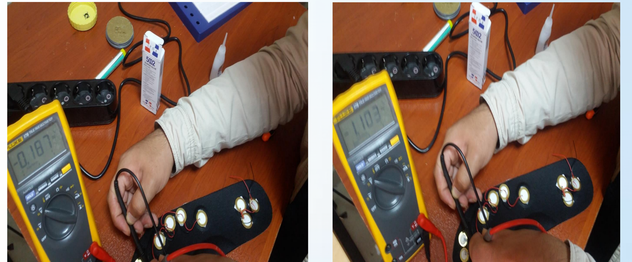
Resim 3. Piezodisklerin açığa çıkardığı gerilim ölçümleri.
