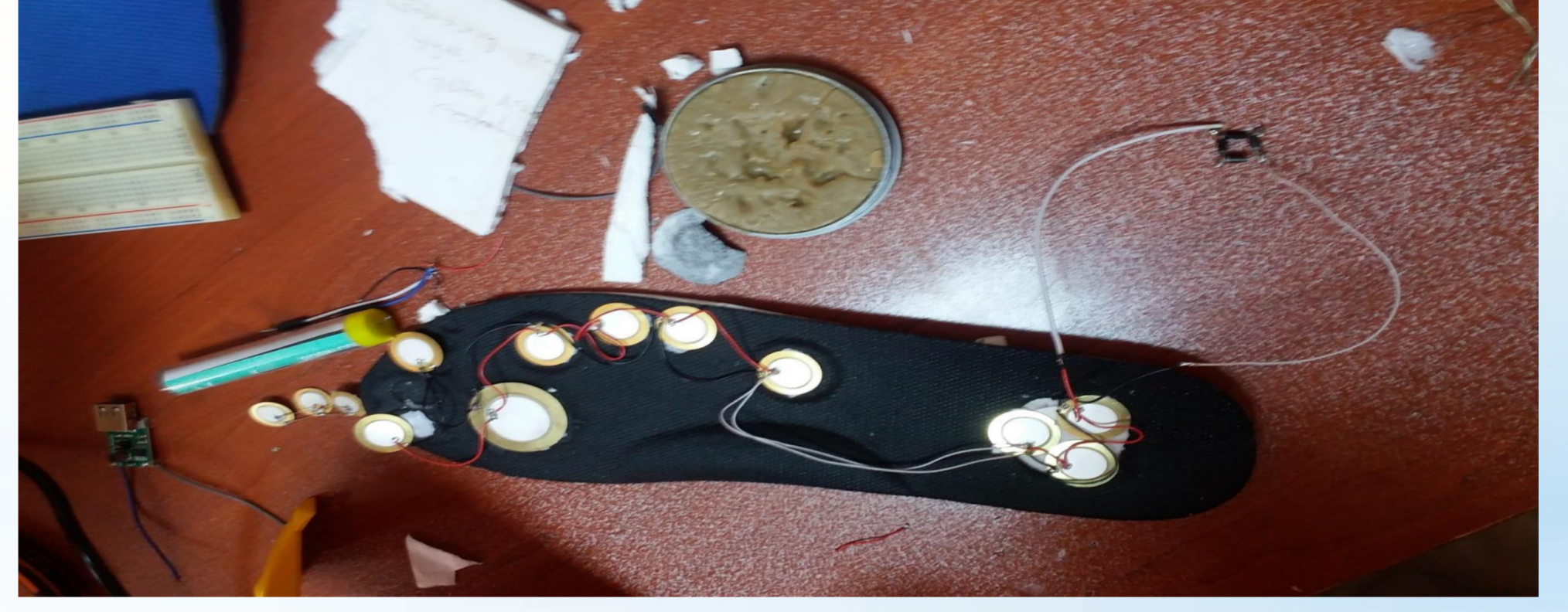
Resim 2. Piezodisklerin bağlantı şekilleri, köprü diyotun bağlantı şekli
