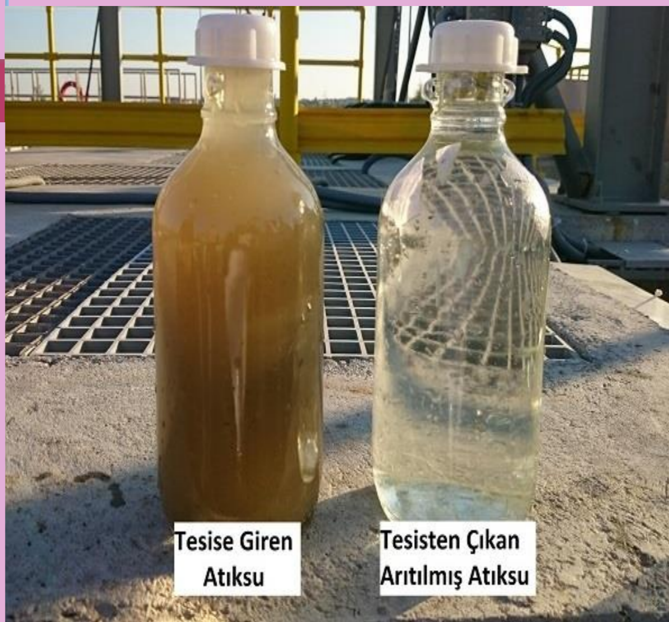
ŞEKİL 5 : Arıtma tesisine giren ve çıkan suyu (hayrabolu arıtma tesisi)
